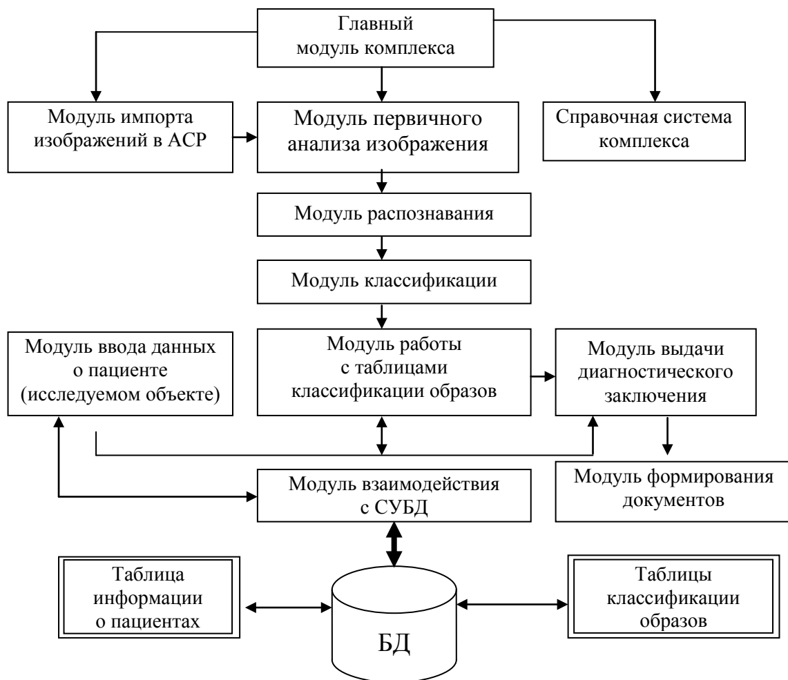
Рис. 2. Структурная схема информационной системы распознавания.
